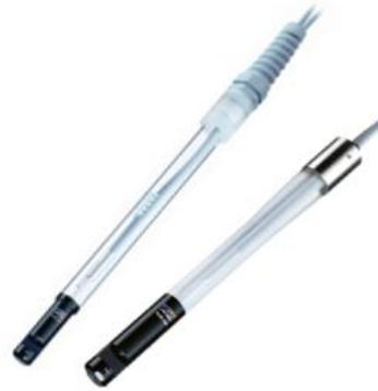
Die Hellma [Excalibur Lab Ganzquarz](#) besitzt einen Messkopf aus Quarzglas »Extended Range«, der flüssigkeitsdicht mit einem Quarzrohr verschmolzen ist. Dadurch sind diese Sonden besonders für Transmissionsmessungen in aggressiven Medien geeignet. Der kollimierte Lichtstrahl durchdringt das zu untersuchende Medium, wie bei einer Küvettenmessung, nur einmal. Der Hellma-typische monolithische Messkopf bietet hohe Transmissions- und geringe Streulichtwerte.
